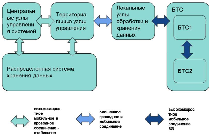
Рис. 3. Архитектура системы группового управления BTS
