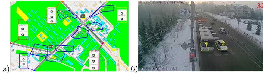
Рис. 1. а) Модель рассматриваемого участка дорожной сети, реализованная в системе ApyLogic; б) зоны дороги (жёлтый цвет), фиксируемые оптическими датчиками
