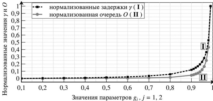
Рис. 2. Зависимости нормализованных задержек  $\gamma$  и очереди  $O$  от  $g_j, j = 1, 2$
