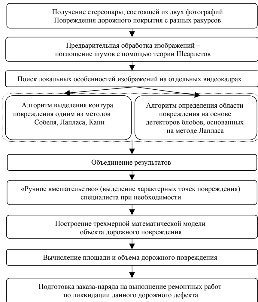
Рис. 1. Структура программно-алгоритмического комплекса распознавания повреждений дорожной поверхности
