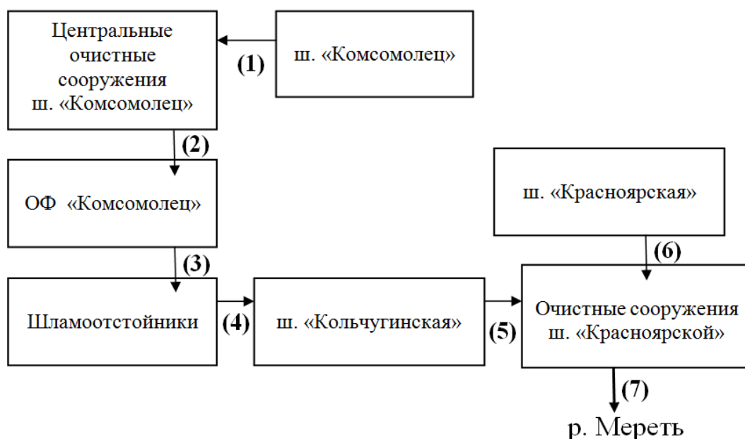
Рис. 1. Схема транзита промышленных стоков ш. «Комсомолец» в р. Мереть. На схеме обозначены процессы: (1) – сброс шахтных вод в центральные очистные сооружения; (2) – отбор вод для использования в технологических процессах обогащения; (3) – сброс для отстаивания в шламоотстойниках; (4) – сброс для очистки в отработанных выработках ш. «Кольчугинская»; (5), (6) – сброс в очистные сооружения ш. «Красноярской»; (7) – сброс очищенных стоков в р. Мереть
