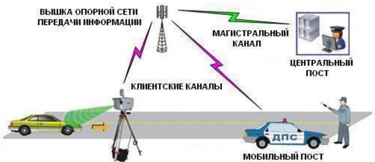
Рис. 2. Фрагмент беспроводной сети, функционирующий в сантиметровом диапазоне радиоволн
